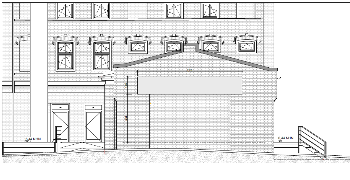
Abbildung 7: Giebelwand von Südosten mit verputztem Fassadenbereich für z.B. ein Werbeschild.
